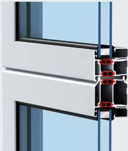
ALR 67 Thermo Glazing с алуминиеви профили с прекъснат термомост
